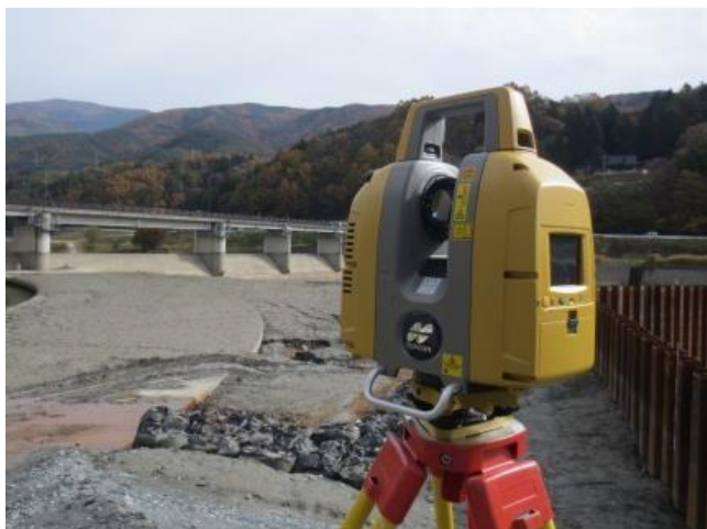
3D計測：地上レーザ
