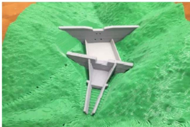
砂防堰堤設計：3Dプリンタモデル
