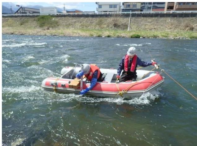
河川流量観測：電磁流速計
