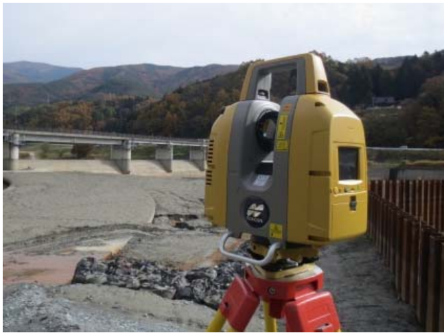
3D計測：地上レーザ
