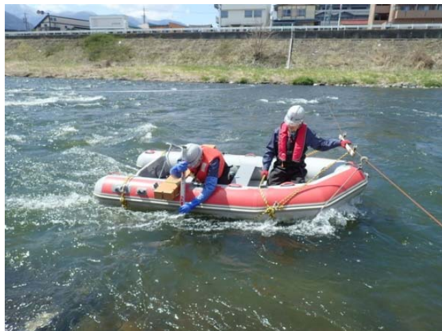
河川流量観測：電磁流速計
