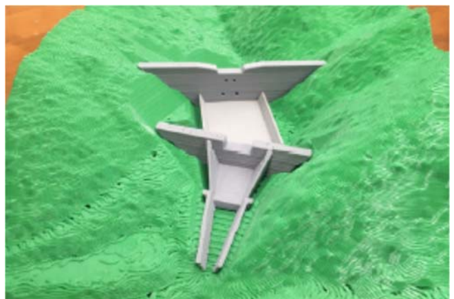
砂防堰堤設計：3Dプリンタモデル
